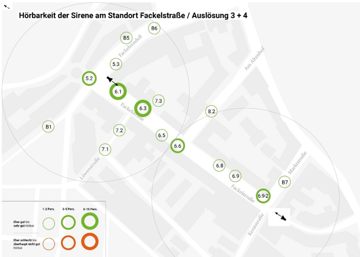
Abbildung 24: Karte aller verfügbaren Bewertungen der Hörbarkeit der Sirene bei der Fackelstraße während der 3. und 4. Auslösung
