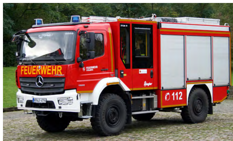
Abb. 26: Beispiel eines geländegängigen Einsatzfahrzeugs vom Typ „Löschgruppenfahrzeug für den Katastrophenschutz“ (LF 20 KatS) (Quelle: CM-Foto/Wolfgang Tribbels)
