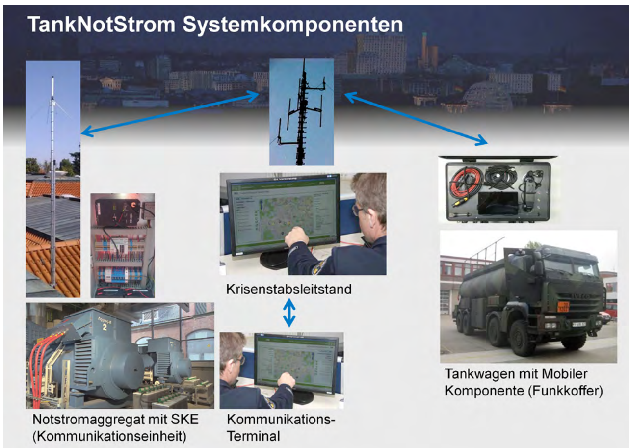
Abbildung 13 TankNotStrom-Systemkomponenten (Bildnachweis:: KomRe AG).
