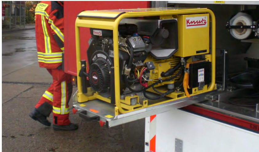
Abbildung 19 Notstromaggregat des GWG (Quelle: M. Tessin).
