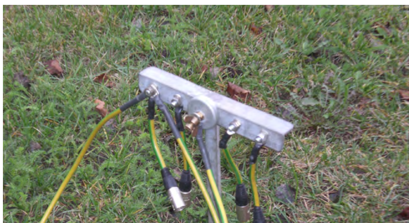
Abbildung 25 Erdungsspieß (Quelle: M. Tessin).
