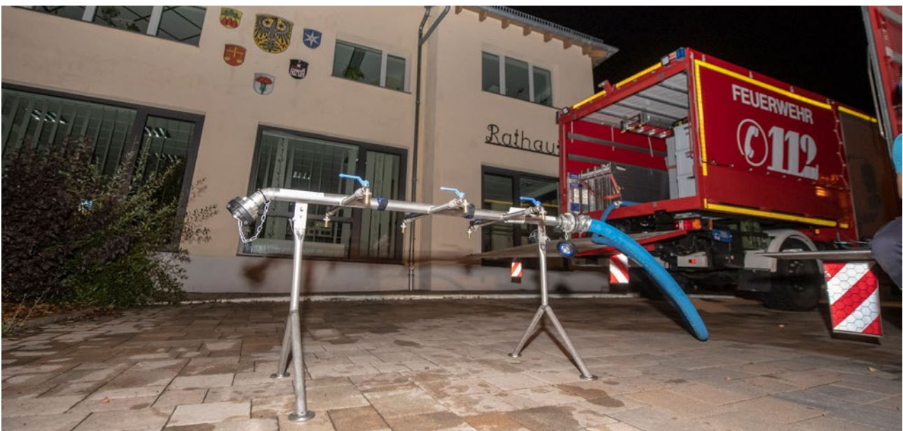
Abbildung 13: Trinkwasserabgabe über Transportfahrzeug an die Bevölkerung (Bildquelle: Reuber, 2018)
