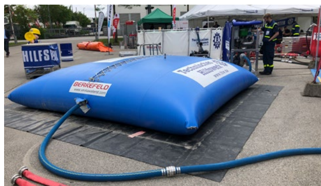
Abbildung 23: Gefüllter, flexibler Speicherbehälter „Bladdertank“ (Bildquelle: SWA)
