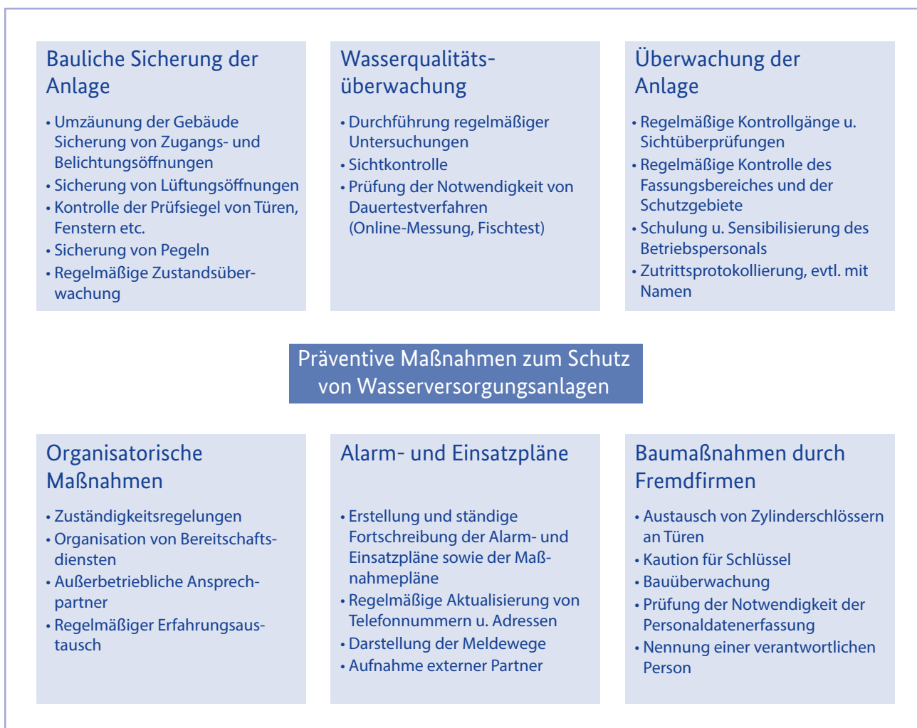
Abb. 10: Zusammenfassung präventiver Maßnahmen zum Schutz von Wasserversorgungsanlagen (eigene Darstellung, in Anlehnung an BMI 2011, DVGW 2012 und SVGW 2010)
