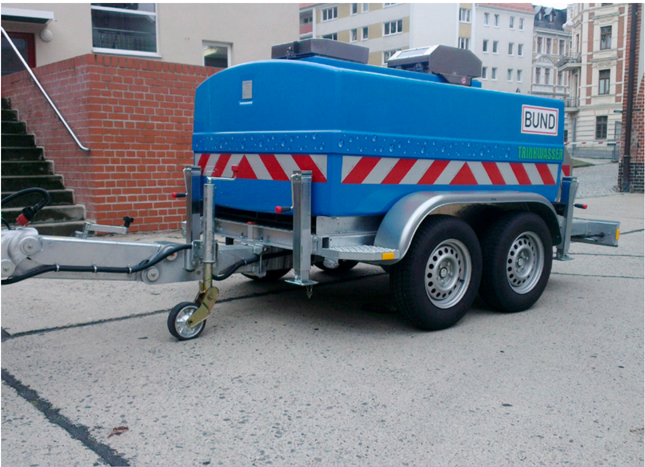
Beispiel eines Anhängers zum Ersatzwassertransport ©Feuerwehr Görlitz
