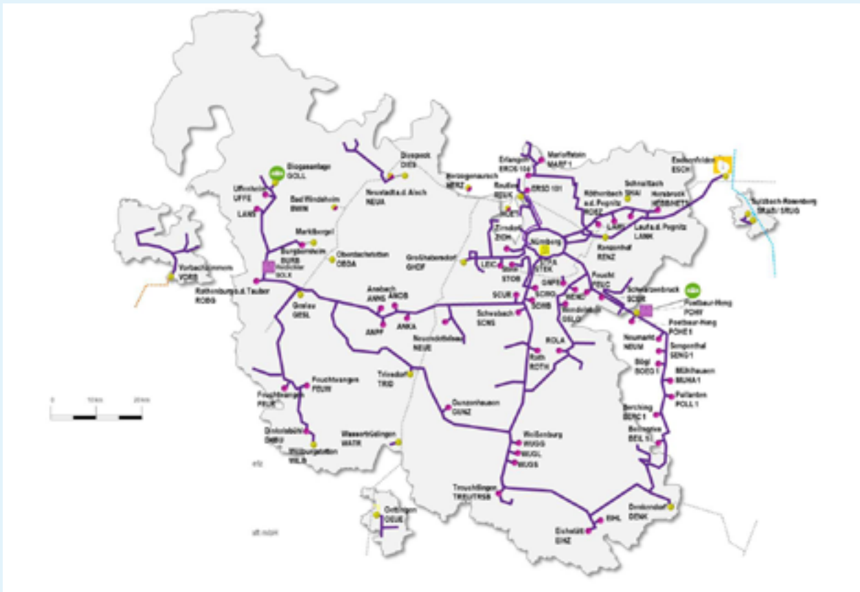
Abb. 18: Verteilnetz der Druckstufen DP 67,5 bar und DP 16 bar der Main-Donau Netzgesellschaft Quelle: MDN
