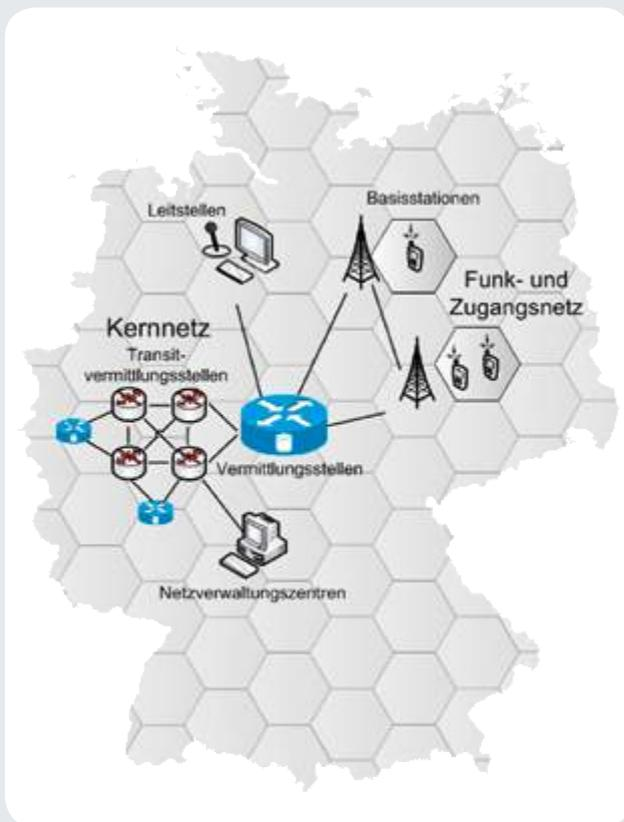
Abb. 13: Schematische Darstellung der Komponenten des BOS-Digitalfunks.
