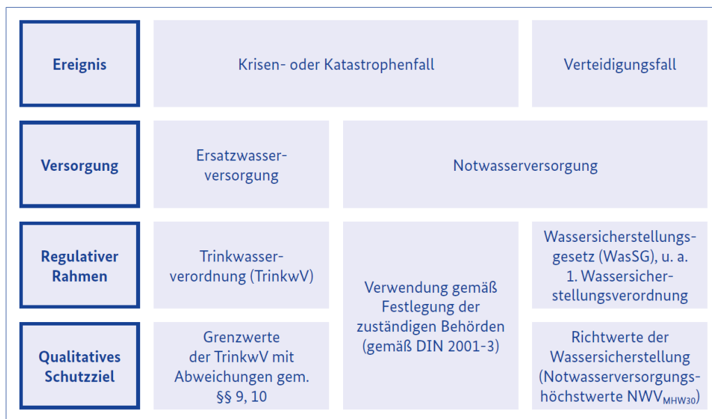
Abb. 1: Begriffe und Anwendungsbereiche der Ersatz- und Notwasserversorgung
