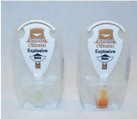
Abbildung 2: Positiver Ammoniumionen-Nachweis; Testsatz: IDenta Quelle: WIS
