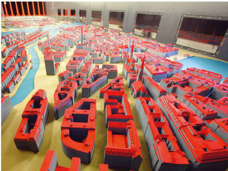
Abbildung 5.2: Das in der Messstrecke des Windkanals aufgebaute Stadtmodell.
