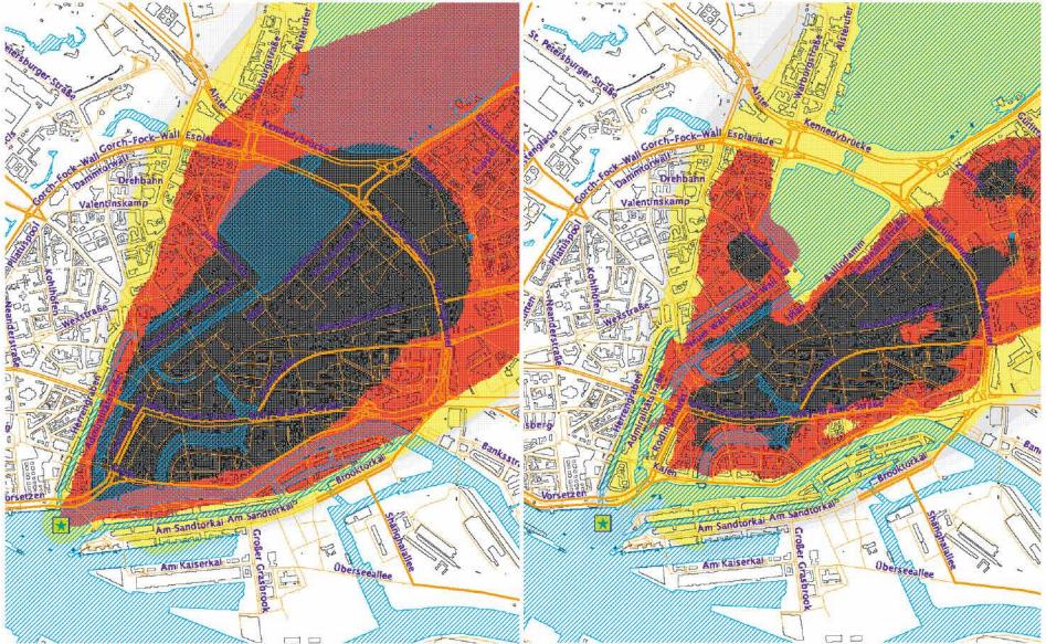
Abbildung 4.8: Gegenüberstellung von CT-Analyst-Simulationsergebnissen (Gefährdungspotenzial ca. neun Minuten nach einer Spontanfreisetzung): links ohne und rechts mit zu Demonstrationszwecken lokal angepasster Ventilationssimulation.
