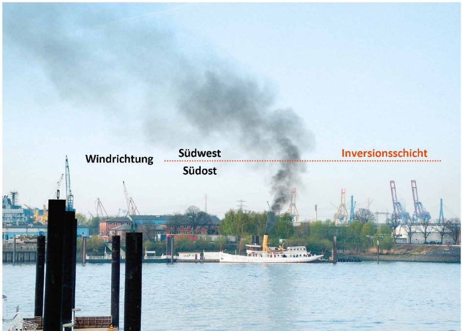
Abbildung 5.19: Markierung der Inversionsschicht im Freisetzungsbereich durch die Abgasfahne des Dampfschiffs „Scharhörn“.
