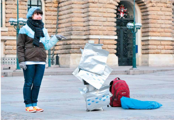
Abbildung 5.16: Auf dem Rathausmarkt Hamburg aufgestellter autonomer Bag-Sampler des FZ Jülich.
