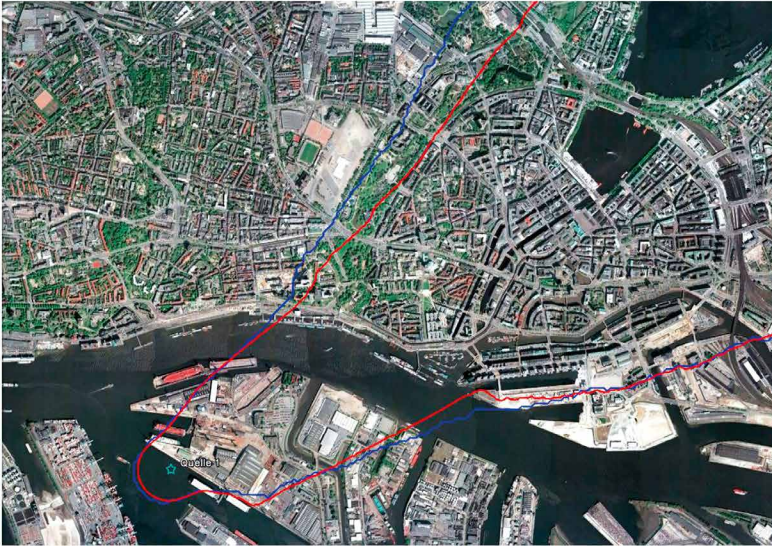
Abbildung 4.7: Von CT-Analyst prognostizierte Gefahrenbereiche, basierend auf 2,5 m Gitterweite (rot) und 10 m Gitterweite (blau) bei LES-Simulationen.
