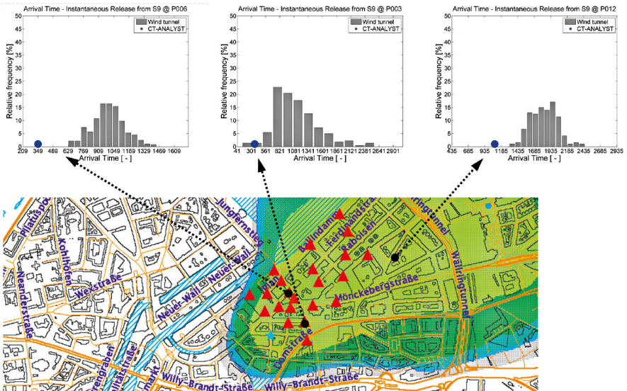
Abbildung 5.54: Verifikation der mit CT-Analyst prognostizierten Reisezeit von Gefahrstoffen für den simulierten Freisetzungsort „Innenstadt“.
