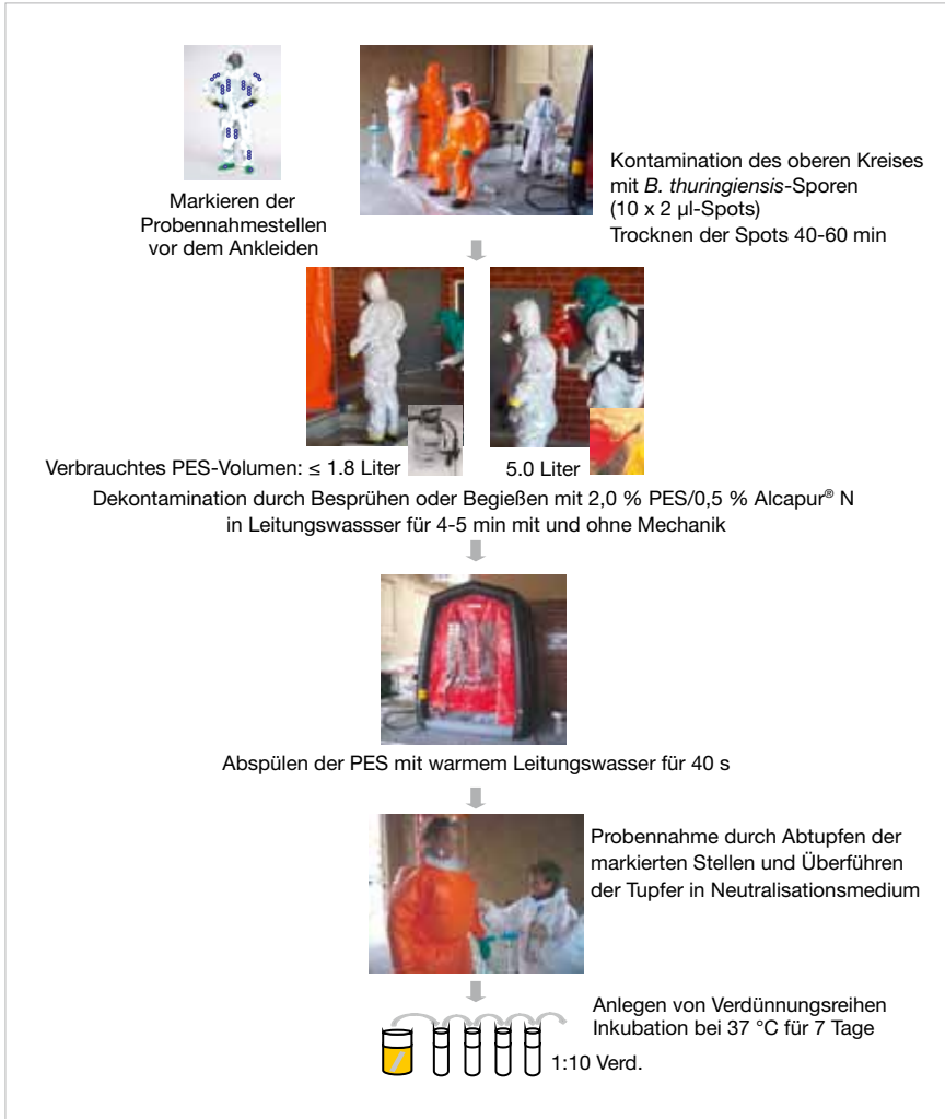
Abb. 9: Schematische Darstellung der Praxisversuche bei der Berliner Feuerwehr am Standort Weißensee. Die Versuche wurden mit Probanden in PSA bei unterschiedlichen Wetterbedingungen in einem überdachten, jedoch seitlich teilweise offenen Areal durchgeführt. Die Dekontamination erfolgte durch Begießen oder Besprühen ohne und mit mechanischer Verteilung der PES/Tensid-Lösung mittels Bürste. (Oberes Foto links mit Person in PSA aus dem Internet. Fotos mit Person in PSA mit Maske von W. Maziejewski, Berliner Feuerwehr.)
