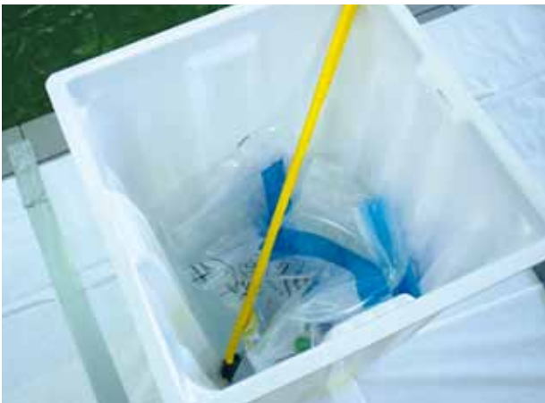
Abb. 3: Beispiel für ein Tauchbad, Probenbeutel können in Dekonlösung getaucht werden.
