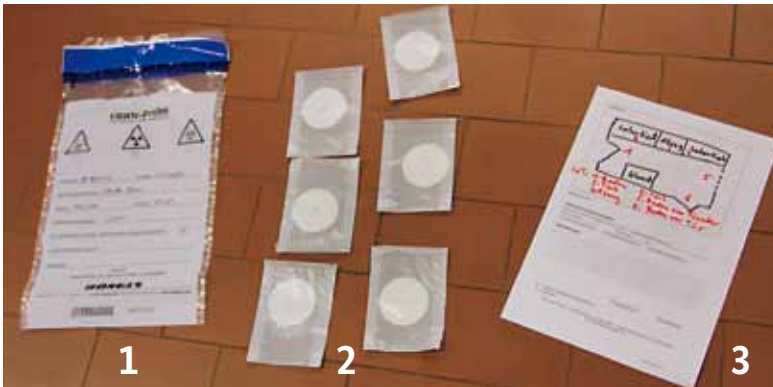
Abb. 22: Bestandteile einer RN-Wischprobe: PE-Beutel (1, Dekonverpackung), Pergamenttasche (2, Primärverpackung) mit Wischproben, Probenbegleitschein (3)
