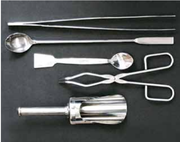
Abb. 9: Geeignete Probenahmematerialien für Feststoffe (von unten nach oben) Schaufel, Tiegelzange, Löffelspatel klein, Löffelspatel groß, Pinzette
