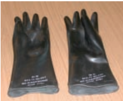
Abb. 3: Schutzhandschuhe aus Butylkautschuk (Foto: BBK)
