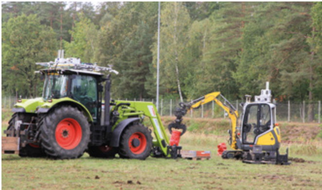
Ein A-KIT aus Sensoren, Rechentechnik und Kommunikationskomponenten ermöglicht Teleoperation und Autonomiefunktionen für Serienfahrzeuge, wie hier beim CLAAS Arion 650 und beim Wacker Neuson ET. (Fotos: Projekt A-KIT)
