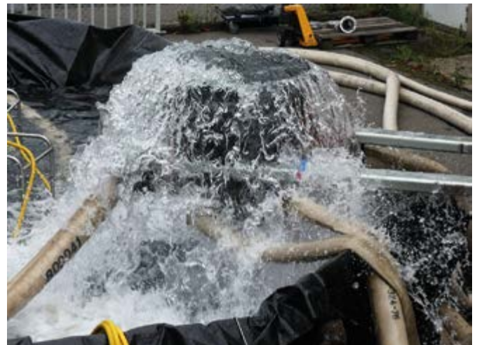
Die umgedrehte SET kann mit einer Unterlegplane als freier Auslauf verwendet werden. (Foto: Helmuth Pfitzmeier)
