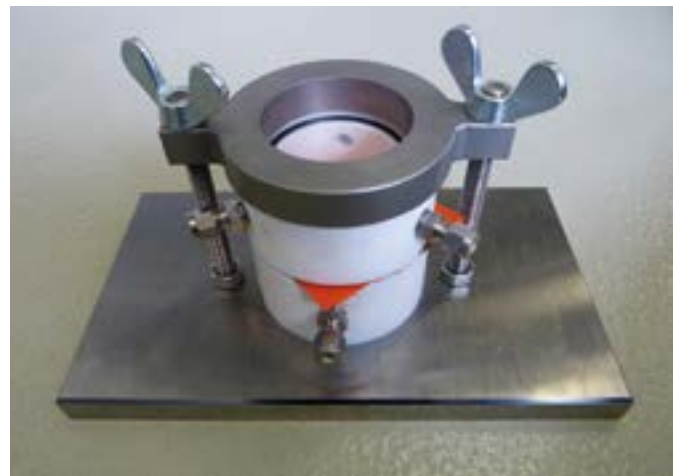
Abbildung 2: Patentierte Apparatur zur Durchbruchprüfung mit eingespanntem Overgarment-Stoff. (Fotos: BBK)
