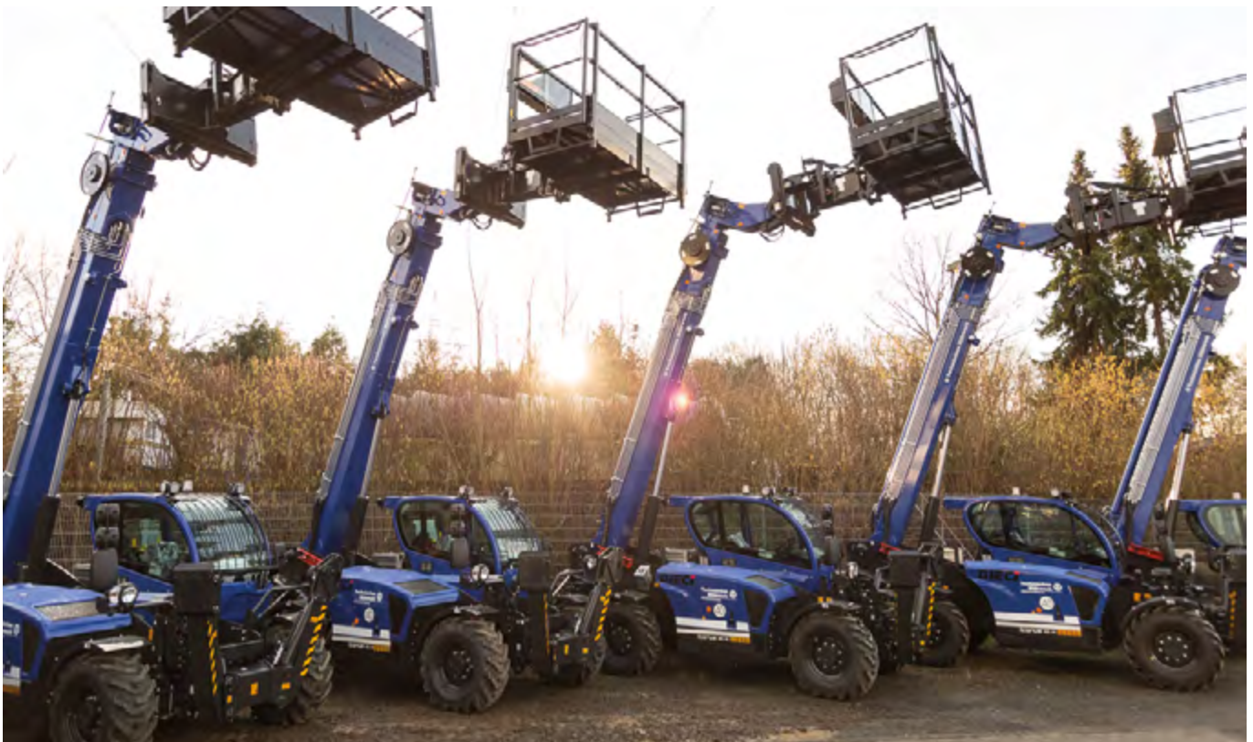
Der Teleskopklader ermöglicht es den Helferinnen und Helfern in der Höhe zu arbeiten. (Foto: THW/Yann Walsdorf)
