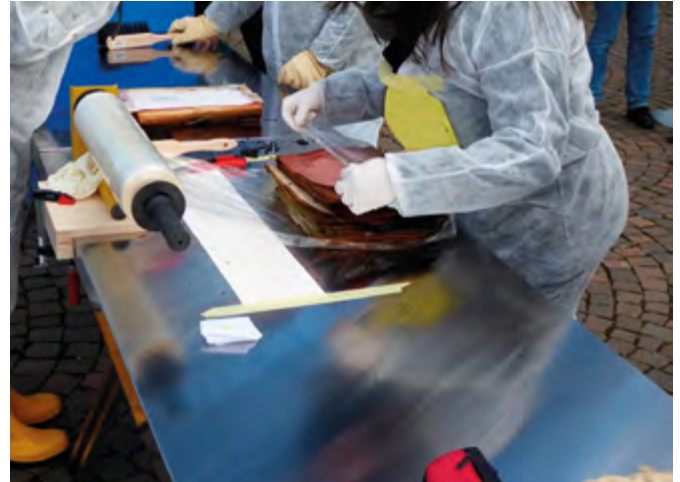
Das ankommende Schriftgut wird bündelweise in Stretchfolie eingepackt, die die Oberfläche schützt, Verklebungen vorbeugt und beim Einfrieren ein Festfrieren der einzelnen Einheiten verhindert. (Fotos: Schindler / Feuerwehr Darmstadt)
