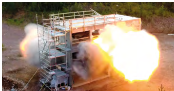
Um die vorab installierten Sensoren zu testen, ließen die Forscher des THW und ihre Partner sogar ein Gebäude errichten und sprengten dieses im Anschluss. (Videoausschnitt: THW)
