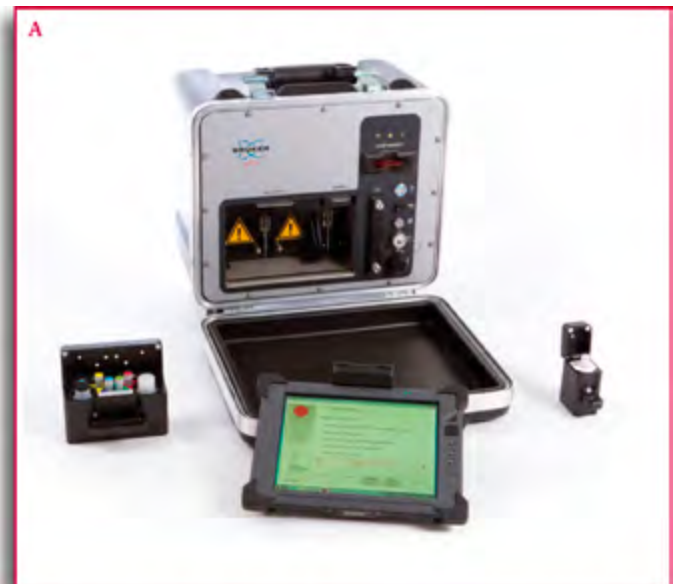
Abbildung 1: Die Biochip-basierte pTDi-Plattform der Bruker Daltonik GmbH. (A) Tragbare pTDi-Plattform (Prototyp) zum Vor-Ort-Nachweis biologischer Agenzien. (B) Darstellung des elektronischen Biochips in der Biochip-Kartusche sowie das Detektionsprinzip.
