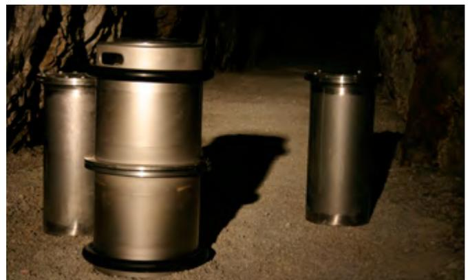
In den luftdichten Edelstahlbehältern wird durch vorherige Klimatisierung ein staub- und schadstofffreies Mikroklima von 35% relativer Luftfeuchte und 10°C erzeugt. (Fotos: BBK)
