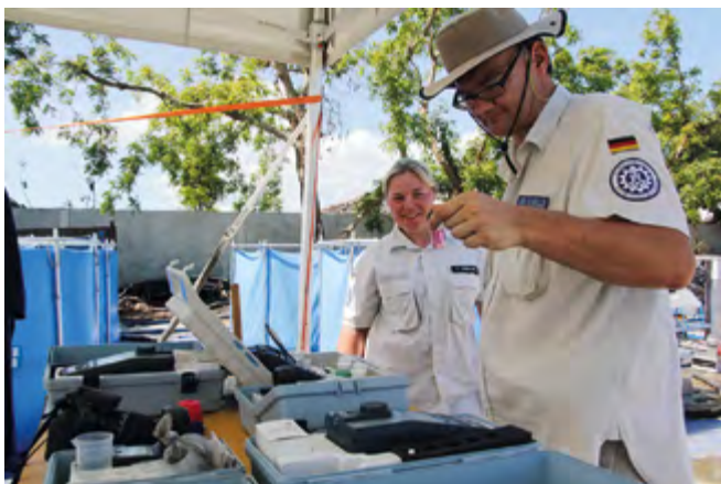
Bevor das aufbereitete Wasser an die Bevölkerung ausgegeben wird, überprüfen THW-Kräfte regelmäßig die Wasserqualität im mitgebrachten Labor. (Fotos: THW)
