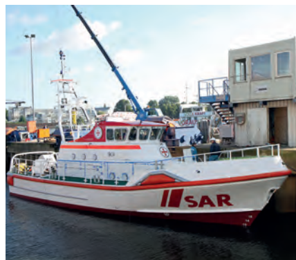
Länge über Alles: 19,90 Meter • Breite über Alles: 5,05 Meter • Tiefgang: 1,30 Meter • Geschwindigkeit: 22 Knoten (ca. 41 km/h) • Besatzung: 7/3 Pers. (Stamm/Einsatz) • Antrieb: ein Propeller 1.220 kW/1.630 PS • Verdrängung: 38 Tonnen (Foto: DGzRS)
