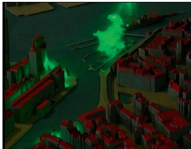
Abb. 4: Ausbreitungsexperiment im Windkanal; Wind aus SW, Sicht von NO auf Kehrwiederspitze, Sportboothafen und Elbe.
