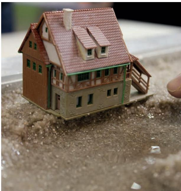
In der Simulation waren Schäden wie Hangabtrag oder Unterspülungen der Häuserfundamente deutlich erkennbar.
