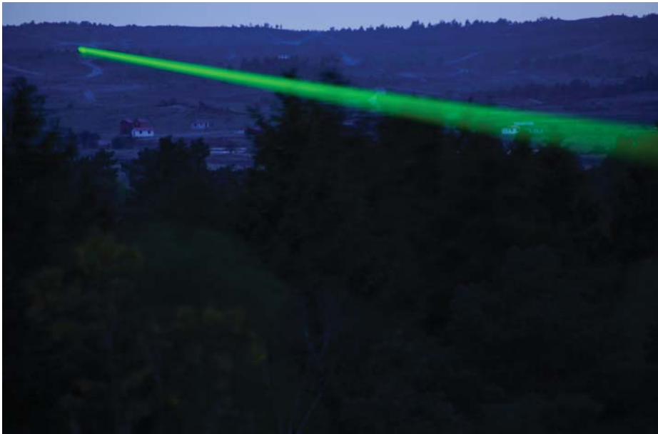
Die mit Lasern erzielbaren hohen Energiedichten im optischen Strahlengang erlauben die Anregung der Aerosole auch auf relativ große Entfernungen, im Bild 5 km Distanz, Laserlicht von 532 nm (grün).
