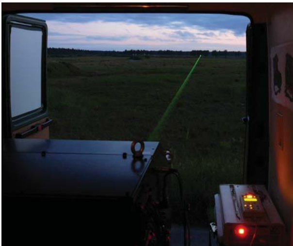
Obwohl eine maximale Mess-Strecke von 5000 m vorgesehen ist, erfolgen die meisten Messungen in ca. 1000 m Entfernung.
