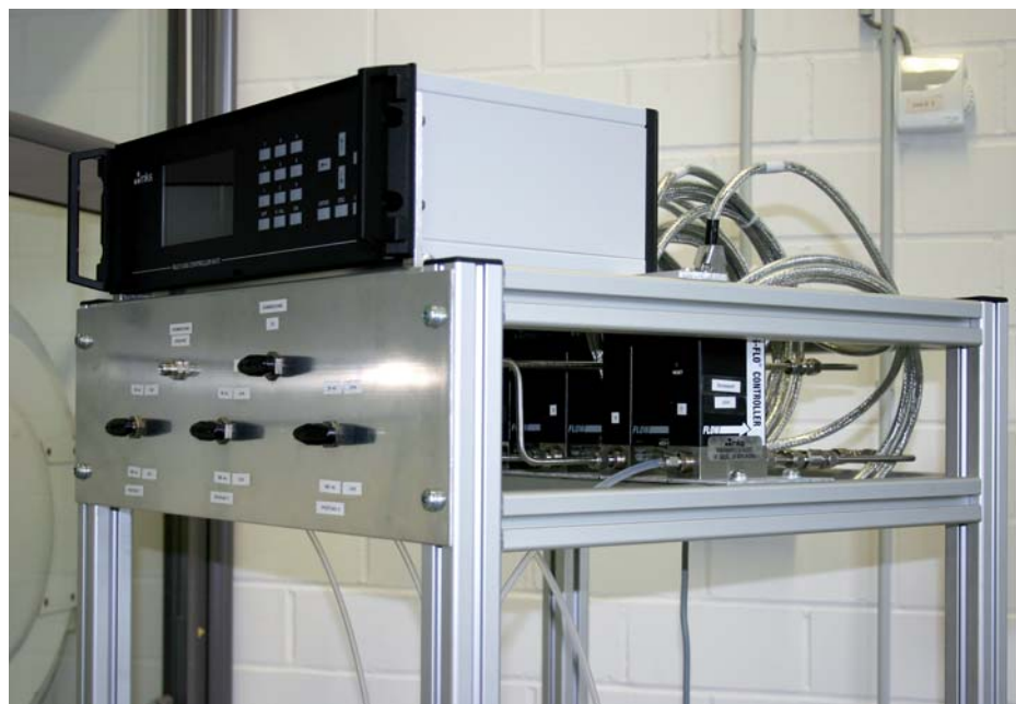
Als Kernelement zur Überprüfung des Funktionsmodells „DACHS“ steht dem BBK eine moderne Mehrkomponenten-Gasmischapparatur zur Verfügung.
