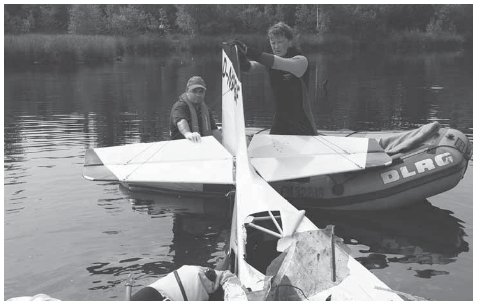
Das Leitwerk der Maschine wird untersucht.
