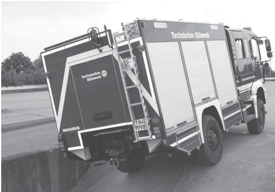
Bei Fahrten im Rückwärtsgang über unebene Strecken ließ sich das Verhalten von Mannschaftskabine und Fahrzeugaufbau beobachten.
