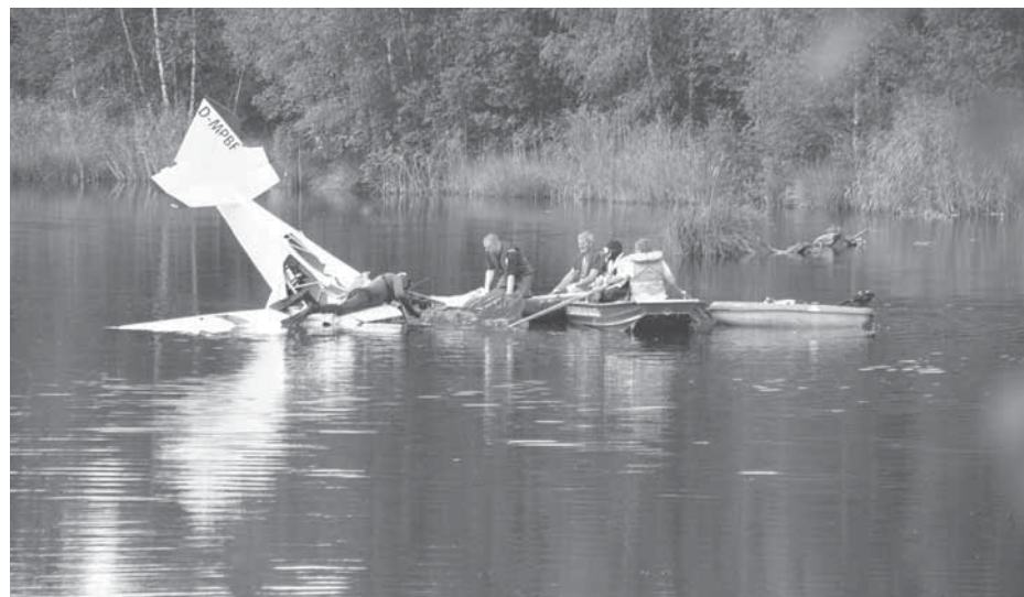
Hebekissen werden am Flugzeug angeschlagen. (Foto: Polizei Ravensburg)
