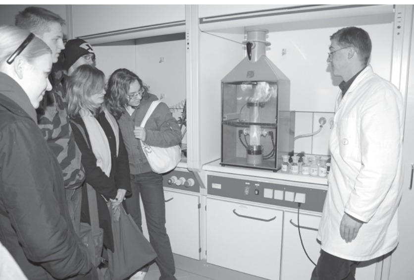
Dipl. Ing. Dieter Gabel führt ein „Modifiziertes Hartmannrohr“ vor. Der Versuch wird genutzt, um Stäube auf deren Explosionsneigung zu testen. (Foto: Karin Lange, Universität Magdeburg)
