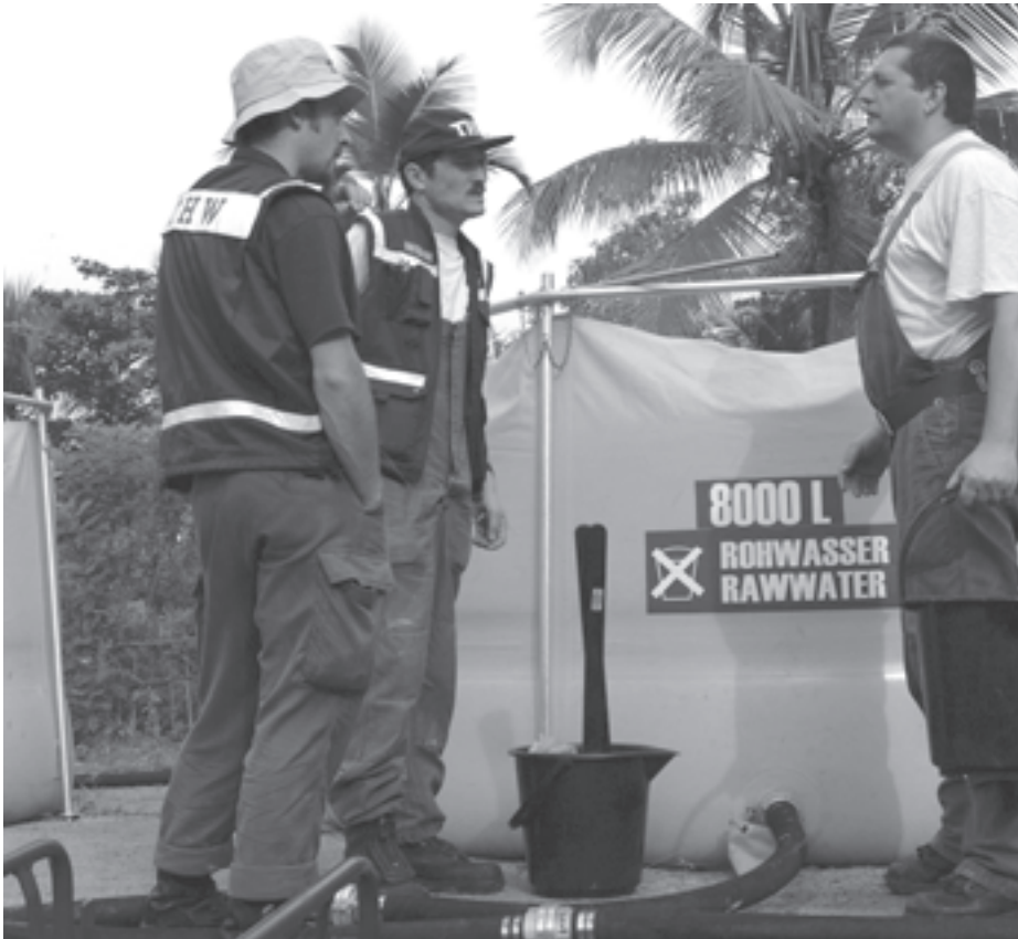
Faltbarer Rohwasserbehälter einer TWA (Trinkwasser-Aufbereitungsanlage).
