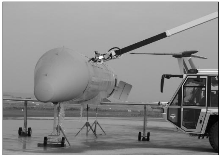
Dank der Piercing-Einrichtung kann die Flugzeugwand durchstoßen und ein Wassernebel im Innern erzeugt werden.
