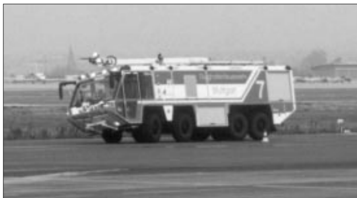
Eine beeindruckende Wendigkeit auch bei hoher Geschwindigkeit zeichnet den 40 t schweren 4-Achser aus. (Fotos: Stein)
