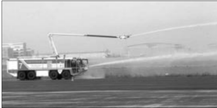
Bereits bei der Anfahrt erfolgt der Löschangriff aus Gelenklöscharm und Frontwerfer.
