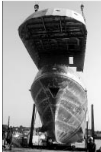
Über dem Aluminiumrumpf des neuen Seenotkreuzers der DGzRS schwebt das Deckshaus, das in wenigen Augenblicken aufgesetzt wird. Im Herbst 2003 soll das 46 Meter lange Spezialschiff in Dienst gestellt werden. (Foto: DGzRS)
