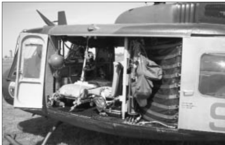
Bell UH-1D; dieser Hubschraubertyp hat nur eine Turbine und entspricht nicht mehr den Richtlinien (JAR-OPS 3) der Luftrettung; er ist bis Ende 2009 zu ersetzen.
