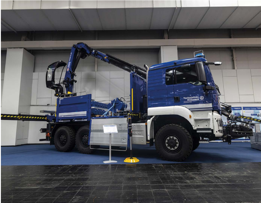
Zur Fahrzeugausstattung der Fachgruppe Wassergefahren gehören neben dem LKW mit Ladekran (6,5 t Nutzlast) zwei Mehrzweckarbeitsboote, zwei Mehrzweckarbeitsbootanhänger und ein Material-Container. (Fotos: THW)
