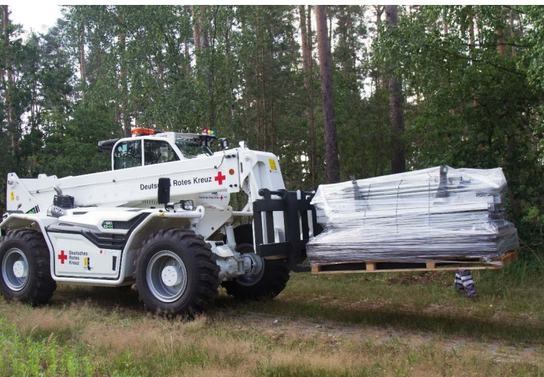
Teleskopstapler mit Allradantrieb zum Verahren, Versetzen und Stapeln von Containern und anderen Materialien im Feld. (Foto: Erdt / DRK)
