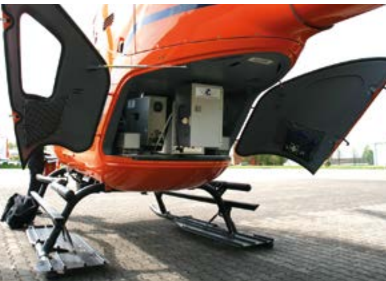
Eingebautes Messsystem in einem Zivilschutz-Hubschrauber. (Foto: Bundesamt für Strahlenschutz)
