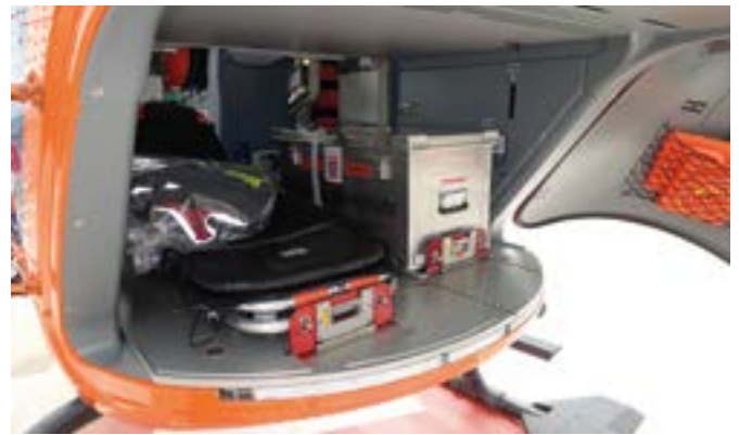
In einem ZSH verlasteter Antidot-Container (Fotos: Ecker, Hessischen Ministerium des Innern und für Sport)
