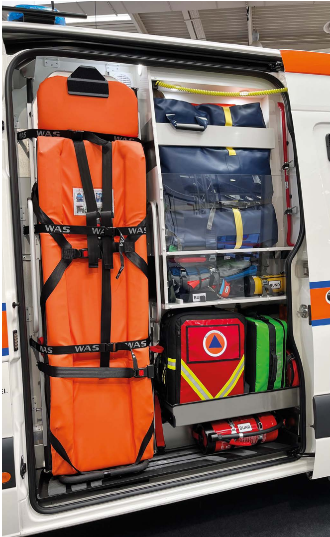
Blick in das neue Außenfach der KTW Typ B. Hier könne unter anderem die zweite Trage und Teile der Notfall- und Bordsausrüstung untergebracht werden. (Fotos: BBK)
