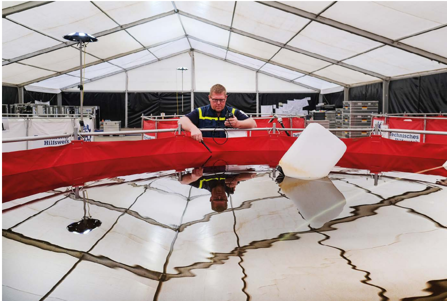
Die Trinkwasseraufbereitungsanlage des THW kann in einer Stunde 15.000 Liter Rohwasser in frisches Trinkwasser verwandeln. (Foto: THW/Kai-Uwe Wärner)
