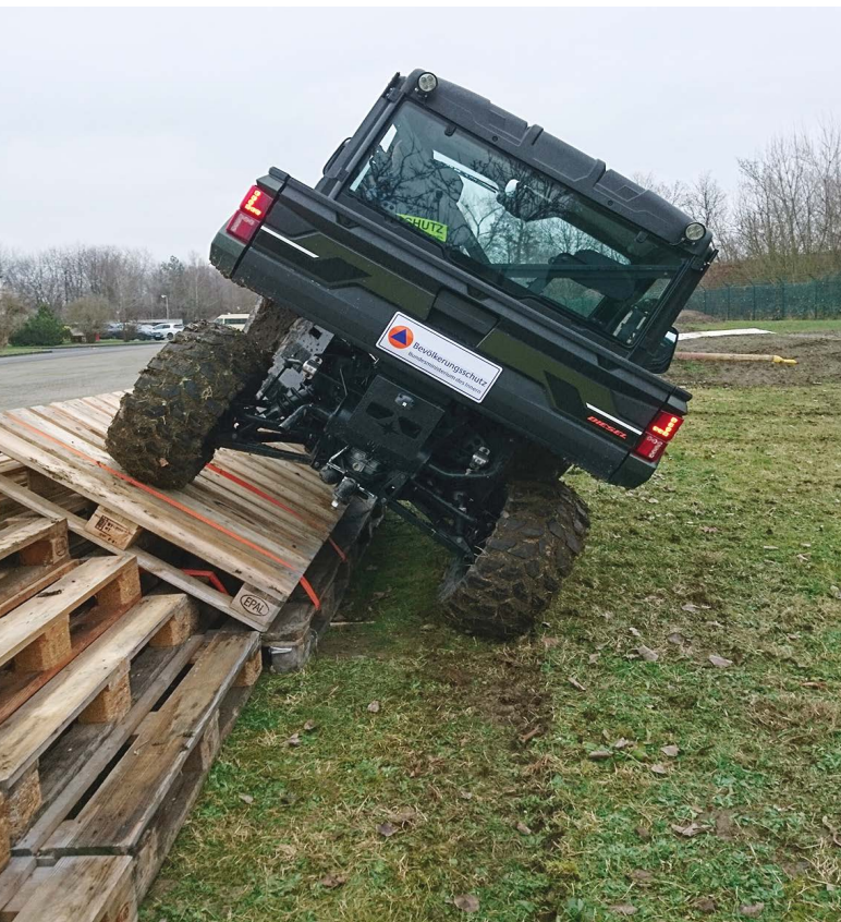
Improvisierte Schrägfahrtstrecke zur Prüfung einer Mobilitätsplattform. (Foto: Gullotta / BBK)
