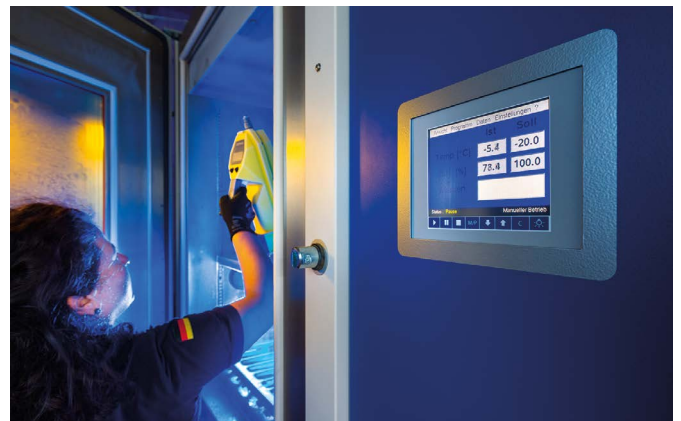
Die Ausstattung des Bundes wird auf ihre Eignung für den Zivilschutz untersucht. Dazu zählt die Prüfung der Einsatzfähigkeit von Messgeräten in einem Temperaturbereich von -20° C bis +40° C in einem Klimaschrank bei verschiedenen Luftfeuchten. (Foto: BBK/BKW/Bernd Lammel)
