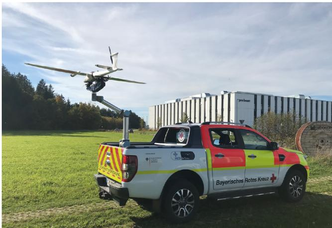
Abbildung 3: Drohne mit Transportmöglichkeit für Medikamente (Fotos: Uwe Kippnich)
