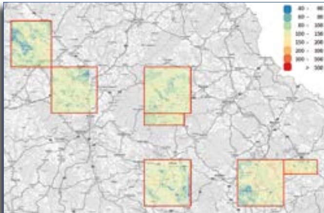
Radiologische Kartierung in Franken; Gesamtmessfläche von 700 Quadratkilometern gemessen in 24 Stunden.
