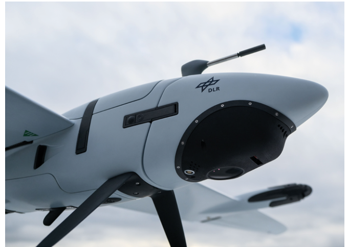
Abbildung 1: MACS-nano Luftbildkamerasystem in VTOL-Drohne Vector. (Quelle: Quantum-Systems GmbH, 2023)
